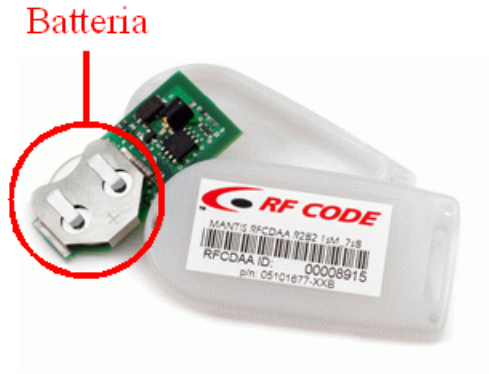
Figura 2: esempio di tag Attivo, nel cerchio rosso è evidenziata la batteria di alimentazione dell' IC (Fonte immagine: http://realtimeid.com/index.html ).
